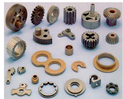
Figura 1 - Peças típicas obtidas através da metalurgia do pó. Trata-se de buchas, pinos, juntas metálicas, bielas de compressores e de motores a combustão interna e uma infinidade de outras, que exigem um certo padrão de qualidade, e que, em inúmeras vezes, poderiam ser fabricadas a partir da sinterização de certas misturas de cavaco proveniente dos processos de usinagem com metais em pó. Foto: GC3M - DEM/FEIS/UNESP. (Foto cedida pela METALPÓ IND. e COM.)
