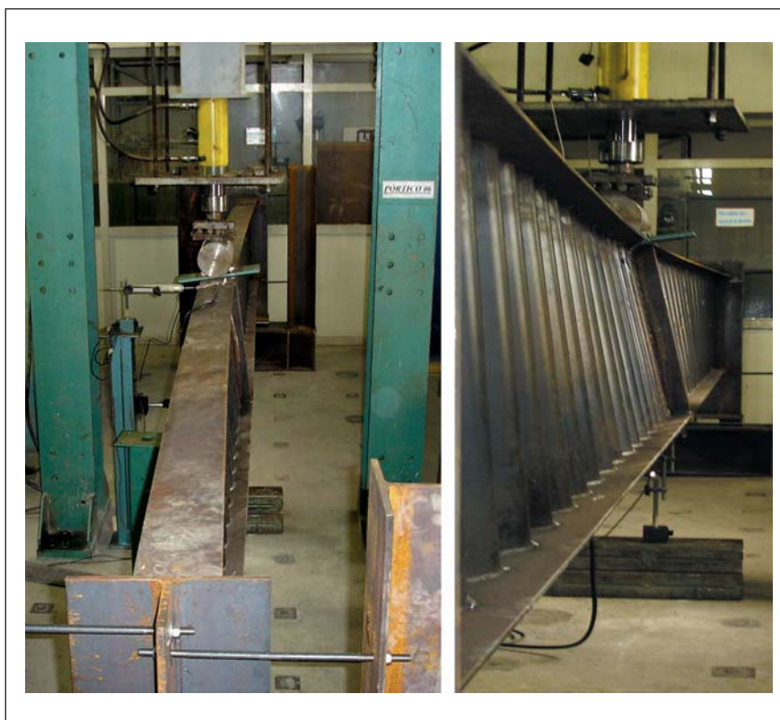
Figura 4 - PSS 600x150x8x2x6000 sem travamento central, após o ensaio.
