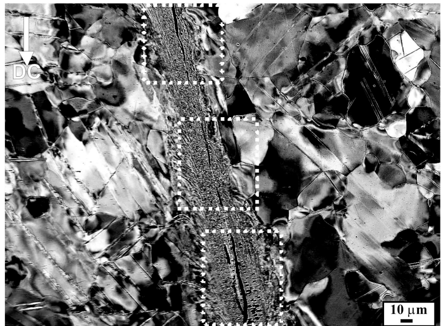
Figura 4 - Micrografia da banda de cisalhamento adiabática induzida no corpo-de-prova A-3. MEV, imagem no modo de elétrons retroespalhados, 20 kV. Notar que, as regiões marcadas nos retângulos brancos, indicam fissuras e cavidades no interior da banda.
