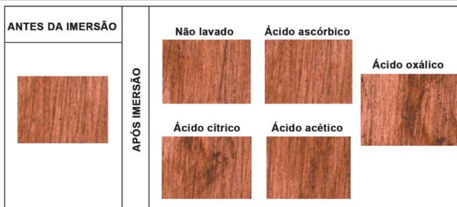
Figura 4 - Micrografias ópticas da chapa de cobre antes e após imersão em amostras de biodiesel, sem e com diferentes tipos de lavagens. Aumento 100 vezes.
