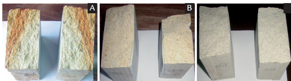
Figura 5 Corpos-de-prova de quartzito rompidos em ensaio de flexão.
