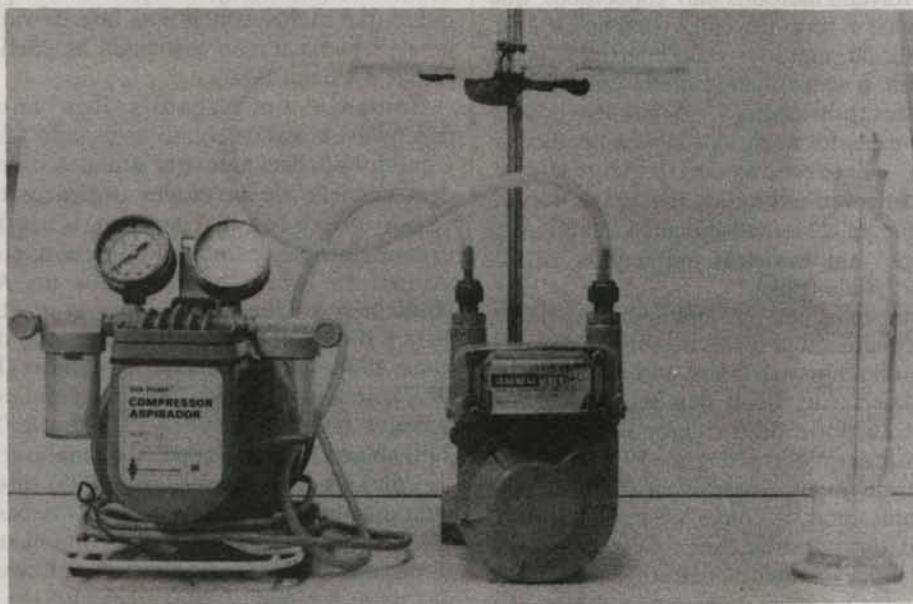
Fig. 1. Amostrador para avaliação da eficiência de coleta de organoclorados no ar.
