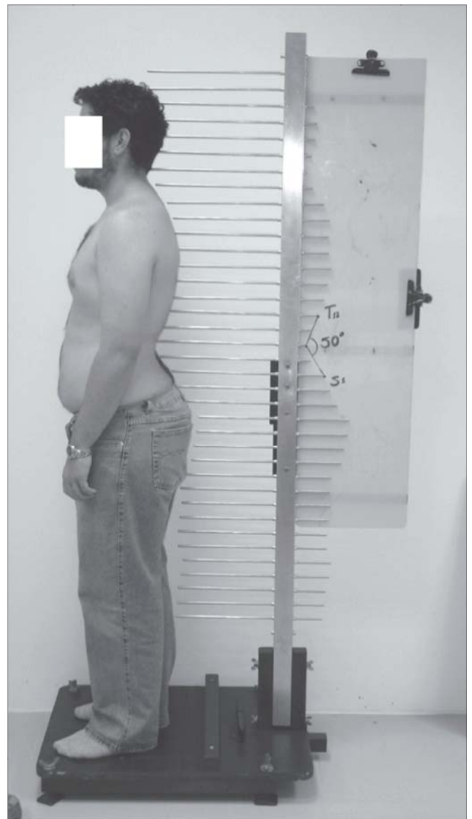
Figura 1. Foto do cifolordômetro, demonstrando o posicionamento do indivíduo e a marcação dos pontos mais proeminentes, referentes a T_{12} e S_1 , e o menos proeminente da curvatura lombar.
