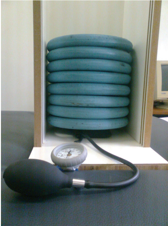
Figura 2. Aparato de madeira para calibração do esfigmomanômetro utilizando anilhas de 5 kg.
