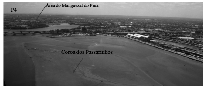
Figura 8 - Foto aérea da área do exutório do manguezal do Pina, em situação de baixa-mar de sizígia, evidenciando a grande deposição de sedimentos com formação de grandes bancos de areia. P4: seção transversal 4 no exutório do rio Pina.
