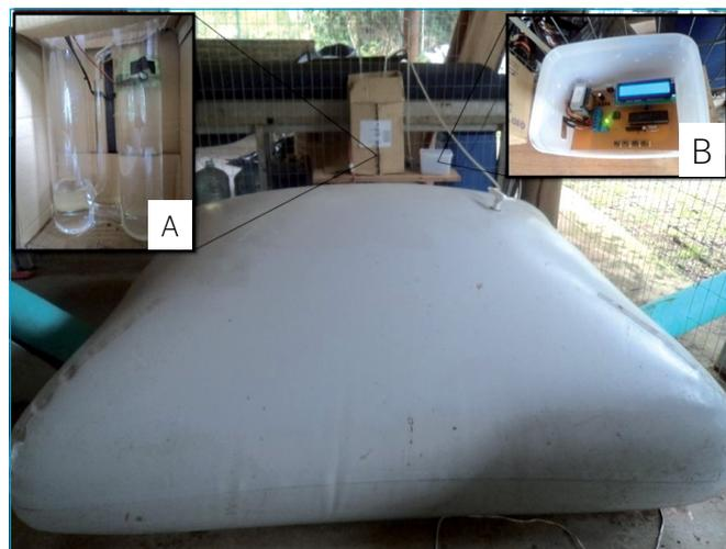
**Figura 1** – Reator anaeróbio com medidor de vazão. O medidor de vazão que monitora o biogás é composto por um sistema de deslocamento de água com sensores (A) e um contador eletrônico (B).
