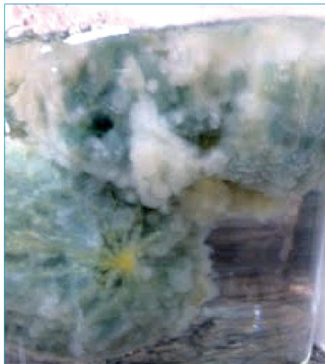
**Figura 1** - Fungos da linhagem *Aspergillus niger* AN400 em crescimento sobre a manta de polipropileno, acondicionada em redes de polietileno, utilizada como material suporte no reator de escoamento contínuo.
