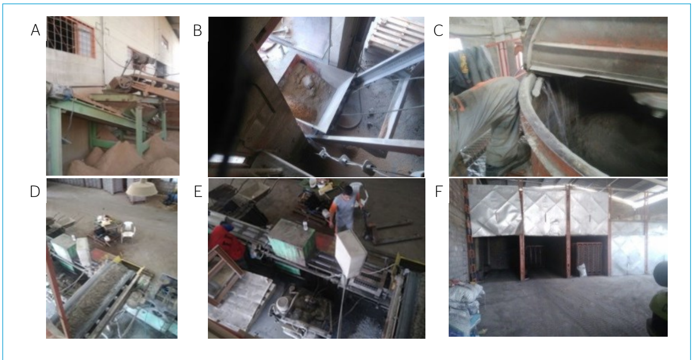
Figura 3 - (A) Peneiramento da areia, (B) Pesagem e elevação de materiais pela tremona, (D) argamassa na esteira, (E) extrusão e (F) secagem estufa.
