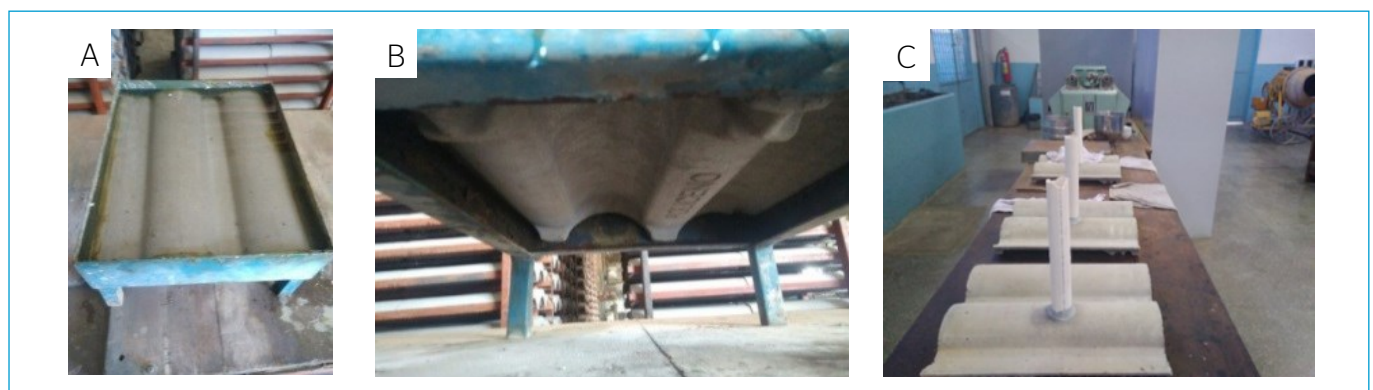
Figura 7 - (A) Telha de polietileno tereftalato (PET) submersa, (B) aspecto da face inferior após 24 horas de ensaio e (C) ensaio de permeabilidade da versão NBR 13.852.2.
