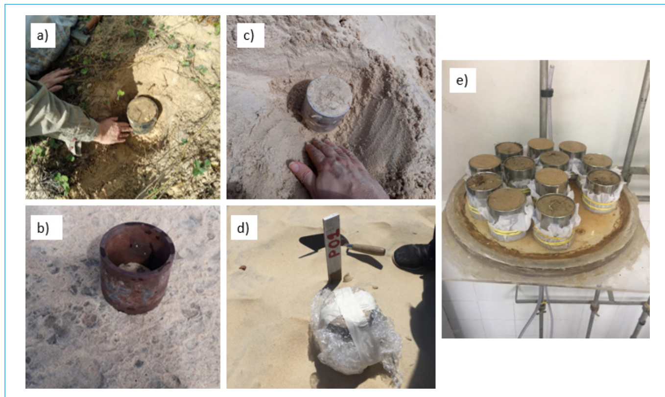
Figura 2 - Cravação e retirada dos cilindros.
