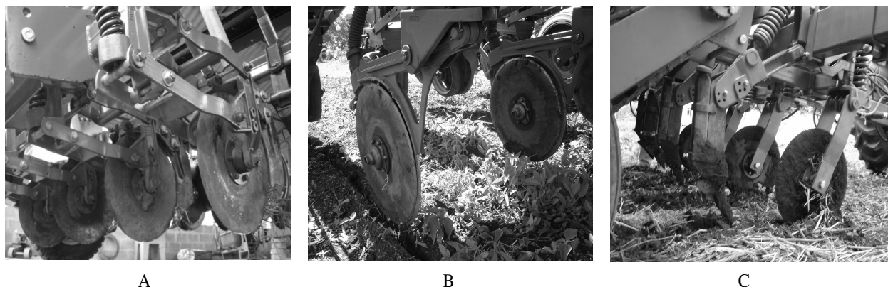
Figura 1 – Detalhes dos mecanismos de abertura do sulco para deposição do adubo.
