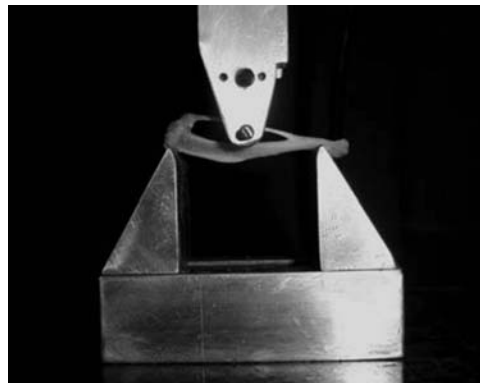
Figura 2 - Imagem de uma tíbia sendo submetida ao ensaio mecânico de flexão em 3 pontos.
