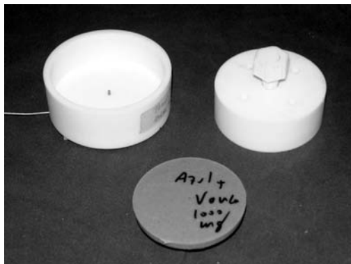
Figura 7 - Termopar inserido na base do molde e cimento retirado após o ensaio para determinação da temperatura máxima.
