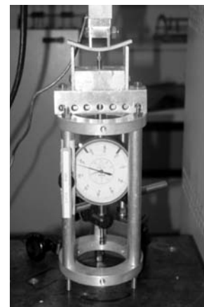
Figura 6 - Dispositivo de ensaio de dobramento a quatro pontos e relógio comparador
