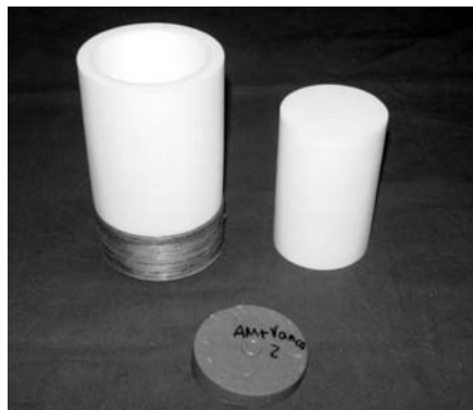
Figura 2 - Molde, êmbolo e cimento endurecido utilizado no ensaio de intrusão.
