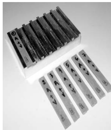
Figura 5 - Molde e corpos de prova utilizados no ensaio de dobramento de cimento
