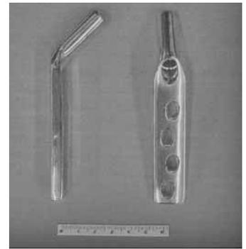
**Figura 1B** – Modelo de Placa Angulada DHS (135°) de quatro furos, de aço inoxidável austenítico ASTM F 138 utilizada para ensaio estático de flexão, grupo II.
