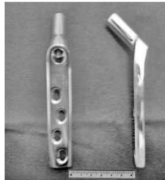
**Figura 1A** – Modelo de Placa Angulada DHS (135°) de quatro furos, de aço inoxidável austenítico ASTM F 138 utilizada para ensaio estático de flexão, grupo I.
