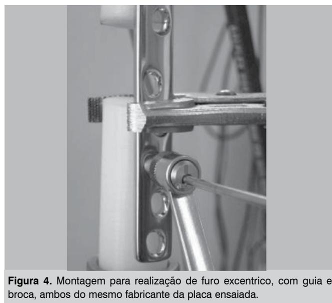
**Figura 4.** Montagem para realização de furo excêntrico, com guia e broca, ambos do mesmo fabricante da placa ensaiada.
