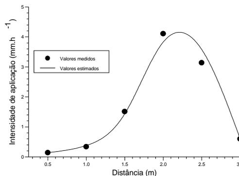
Figura 2 Perfil de distribuição de água do microaspersor RAIN-BIRD QN-14, operando sob uma pressão de 150 kPa e velocidade de vento nulo
