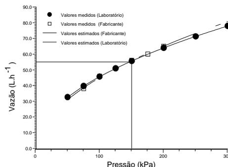
Figura 1 Representação gráfica da equação característica de vazão versus pressão do microaspersor RAIN- BIRD QN-14
