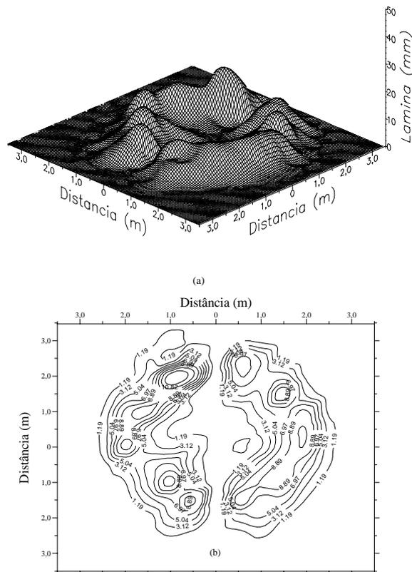
Figura 3 Perfil tridimensional (a) e Isoietas (b) do microaspersor RAIN-BIRD QN-14, sob pressão de 150 kPa, em condição de laboratório
