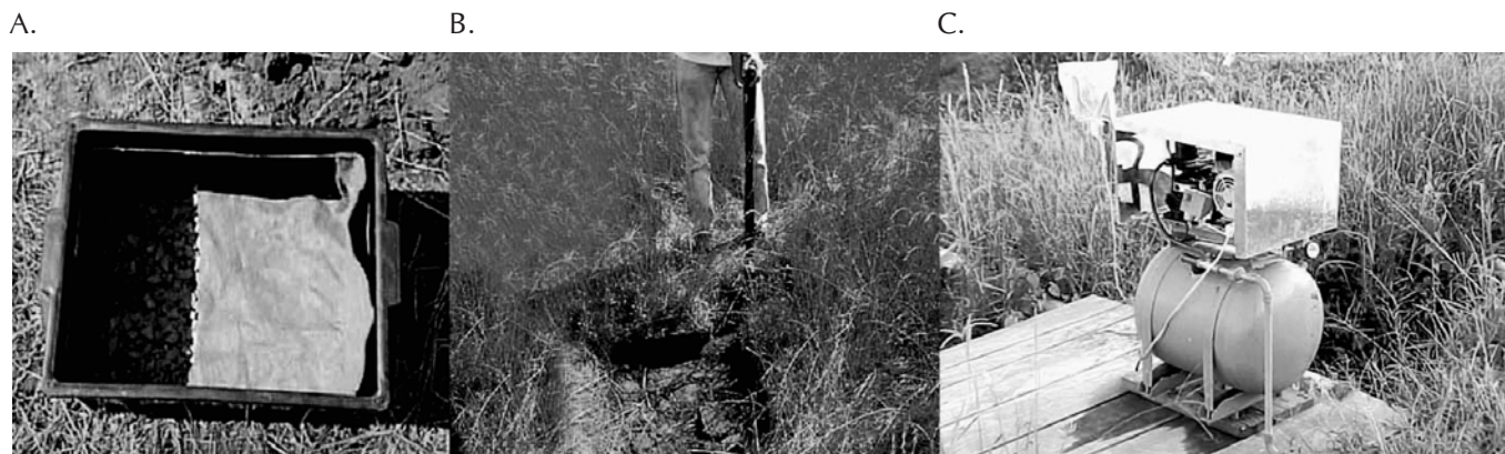
Figura 2. (A) Minilímetro com brita e bidim, (B) local de instalação e (C) bomba de vácuo.
