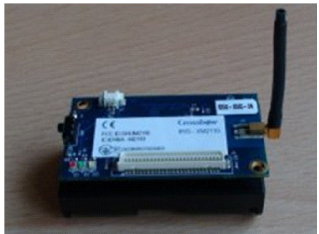
Figura 4. (A) Placa de aquisição MDA300CA; (B) nó sensor com plataforma IRIS®
