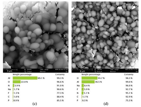
Figure 2. Particles micrographs / EDS (a) C, (b) CNaF0.05 e (d) CNaF2 10.000X, and (c) CNaF0.2 20.000X.
