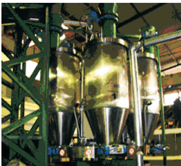
Figura 3 - Esterilizador de farinha de carne e ossos com dois tanques e os transportadores, fabricado pela empresa Beta Engenharia.
