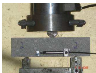
Figura 15: Esquema de ensaio à flexão das amostras cortadas do bloco a três pontos.
