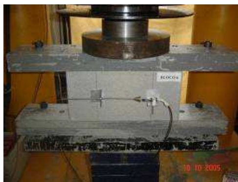
Figura 3: Esquema de teste para o módulo de elasticidade e Poisson.
