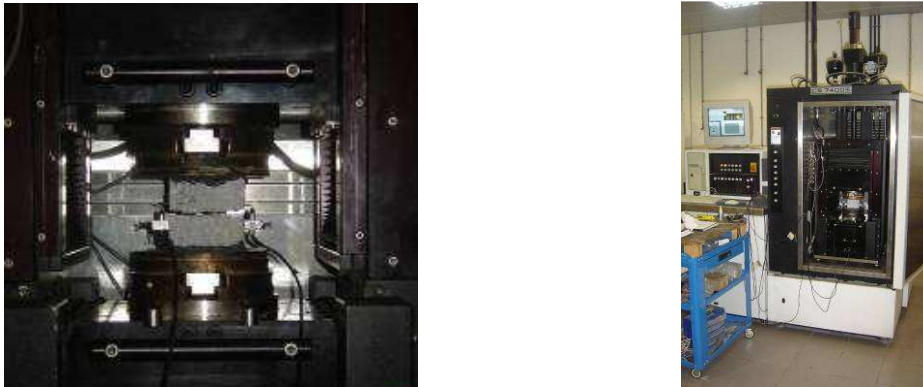
Figura 13: Dispositivo para o ensaio de tração e máquina universal de tração.
