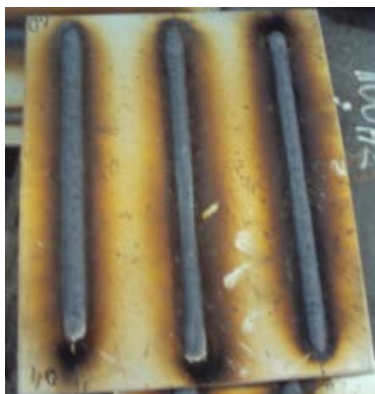
Figura 1: Chapa de aço duplex SAF 2205 soldada com aporte térmico de 1,0 kJ/mm.
