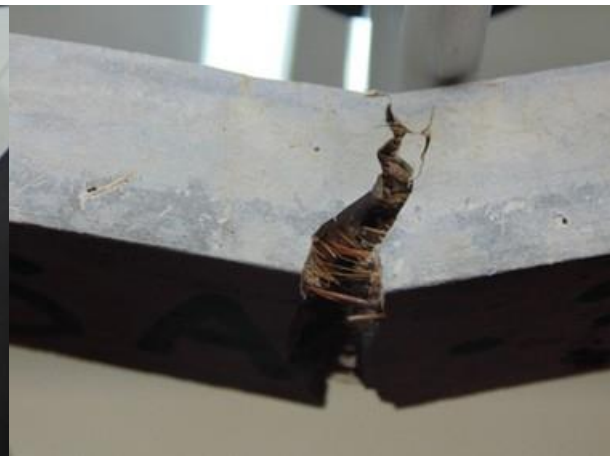
Figura 11: Imagens dos corpos de prova F-N com e sem processo de ciclagem (A); do rompimento do corpo de prova F-N sem ciclagem (B); da fissuração do corpo de prova S-L sem ciclagem (C); do rompimento do corpo de prova S-F sem
