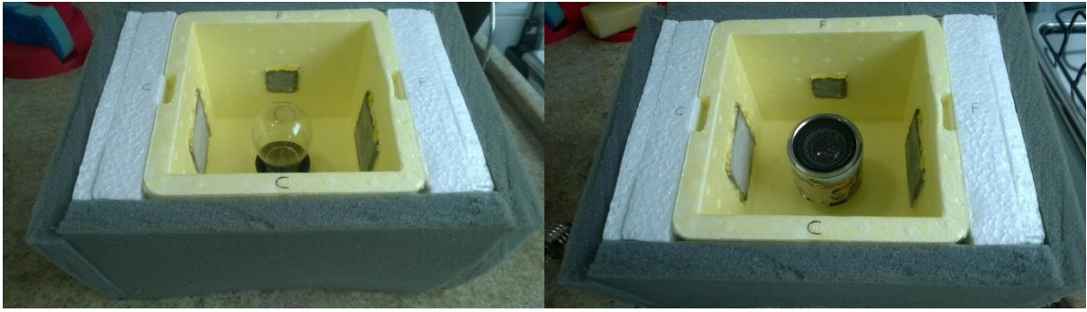
Figura 3: Caixa com a fonte de calor instalada – lâmpada incandescente (A); caixa com a fonte sonora instalada – caixa de som portátil (B).
