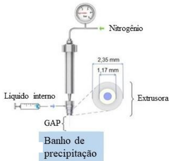
Figura 3: Extrusora utilizada para preparação das membranas.
