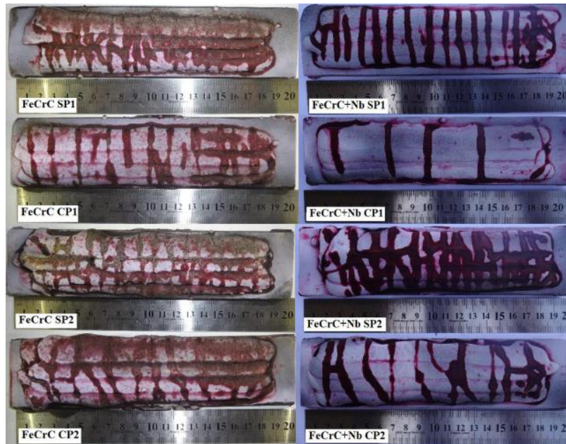
Figura 3: Resultado do ensaio de líquido penetrante. Revestimentos das ligas FeCrC e FeCrC + Nb, em uma e duas camadas.
