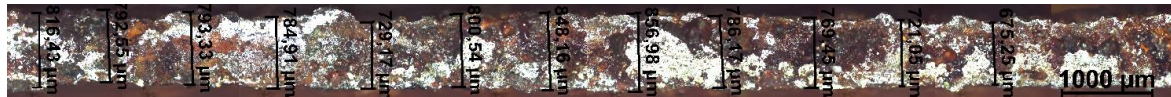
Figura 5: Mosaico obtido para seção transversal do revestimento para a condição 4 da amostra não embutida. As medidas de espessura da camada aspergida variam no entorno de 0,77 mm
