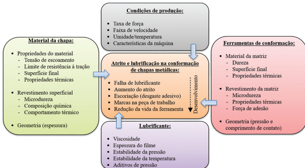
Figura 1: Fatores que afetam o atrito e a lubrificação na conformação de chapas metálicas. Adaptado de ALTAN e TEKKAYA [8].
