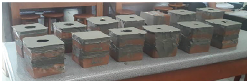
c) corpos de prova dos tijolos preparados para ensaio de resistência à compressão
