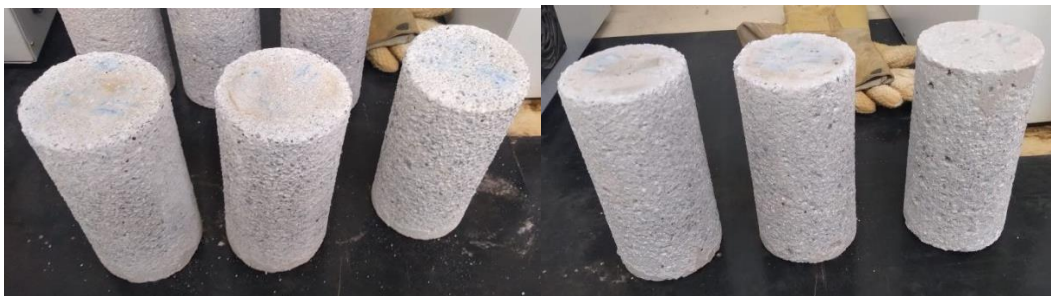
Figura 8: Corpos de prova após perda de massa por ataque ácido (TR-0, à esquerda; TR-100, à direita)
