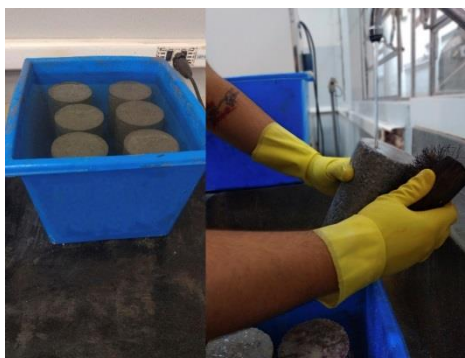
Figura 7: Abrasão do corpo de prova com escova de aço após 7 dias
