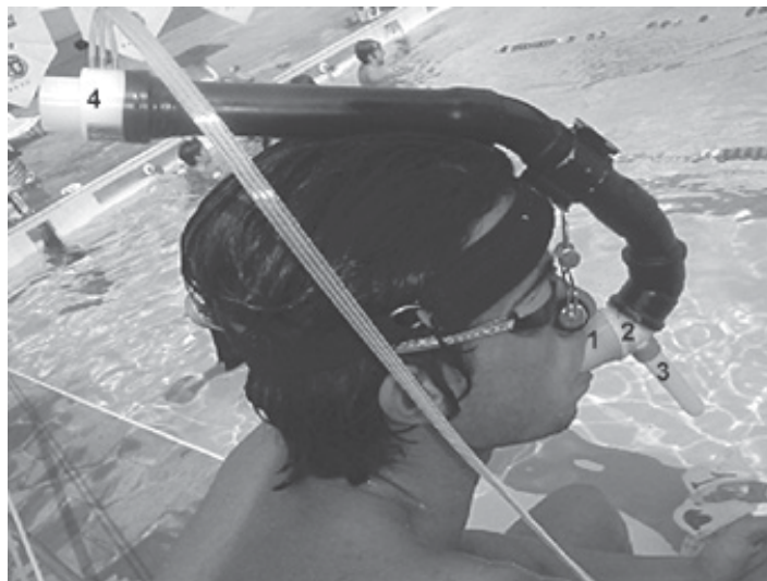
Figura 1 – Representação do snorkel desenvolvido para mensuração de parâmetros cardiorrespiratórios em natação
