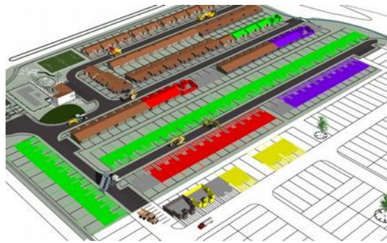
Figura 6 - Visualização 4D com radiers iniciando-se sem o serviço de terraplanagem concluído
