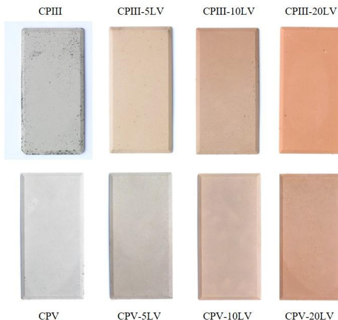
Figura 2 - Pisos moldados com os diferentes cimentos e teores de lama vermelha
