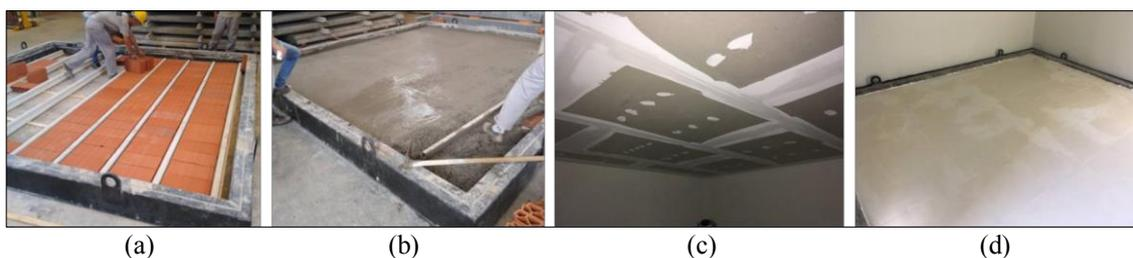
Figura 2 - Instalação da amostra e da câmara de emissão para o ensaio de ruído de impacto: (a) içamento da amostra de ensaio; e (b) sobreposição da câmara de emissão
