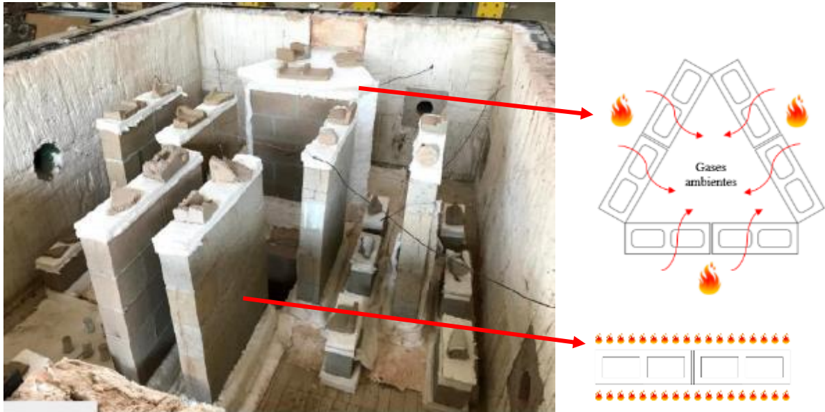
Figura 3 - Ensaios de Dupim (2019): paredes expostas ao fogo em uma e em ambas as faces
