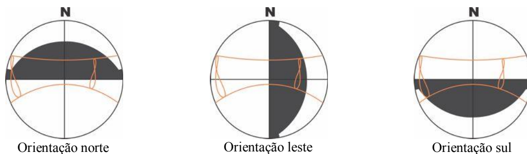
Figura 3 - Máscaras de sombra da janela dos modelos, nas orientações norte, leste e sul e na localização de Salvador, BA
