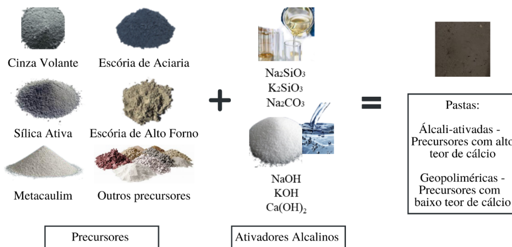
Figura 1 - Principais constituintes dos ligantes geopoliméricos
