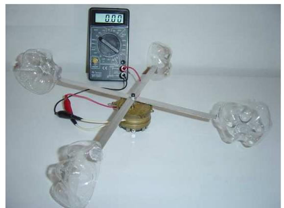
Figura 2 - Anemômetro construído com materiais de baixo custo, formado basicamente por um gerador elétrico, um sistema de hélices e um voltímetro.
