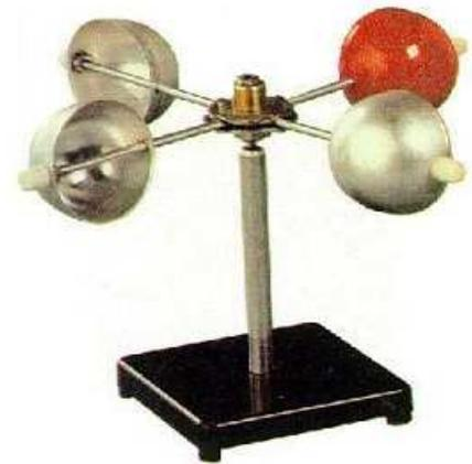
Figura 1 - Anemômetro comercial usado em estações meteorológicas para determinação da velocidade dos ventos.
