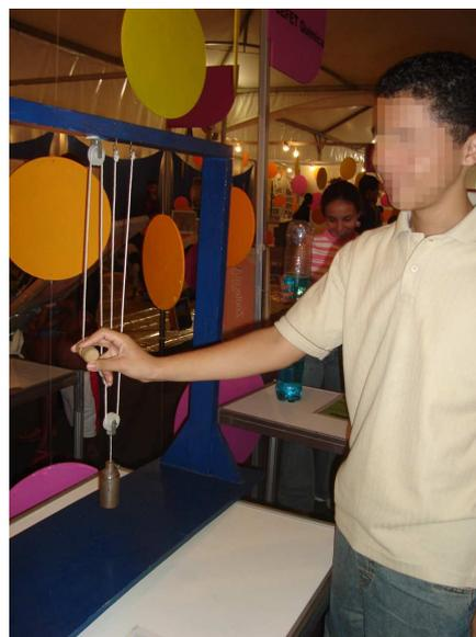
Figura 6 - Equipamento interativo “Sistema de roldanas”. Modelo construído com ripas e tábua de madeira, cordas e carretilhas de nylon. Os “pesos” são de “fios de prumo” usados em construções, com 1 kg cada um. Em outros modelos usam-se como “pesos” sacos de pano contendo areia. Local da foto: Escola Municipal Monteiro Lobato, Nova Iguaçu/RJ. Ano: 2007. Autor da foto: Grazielle Rodrigues Pereira.
