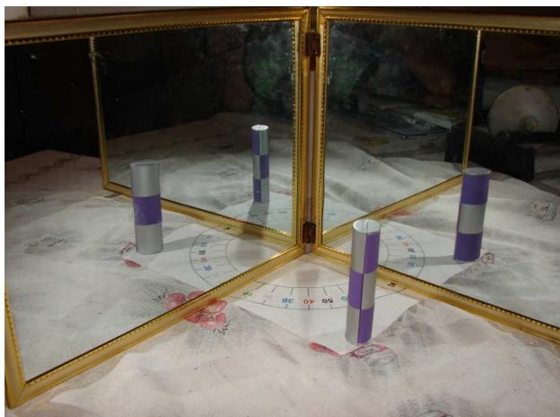
Figura 8 - Equipamento interativo “Espelhos em ângulos”. Modelo construído com espelhos comuns e dobradiças. Foi acrescentado um transferidor, para possibilitar conclusões relacionadas a ângulos. Local da foto: CEFET Química, Nilópolis/RJ. Ano: 2007. Autor da foto: Jair Augusto Gomes de Sant’Ana.
