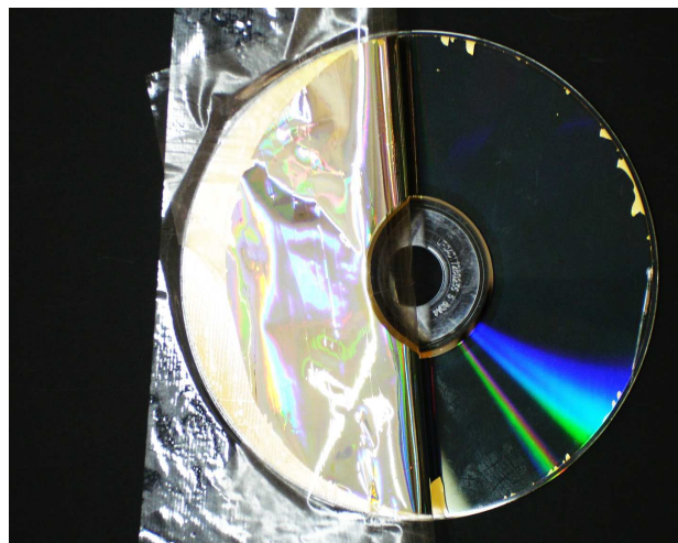
Figura 1 - O CD gravável, com sua película protetora sendo retirada por meio de fita adesiva.
