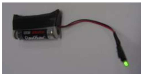
Figura 8 - LED verde acoplado a baterías.
