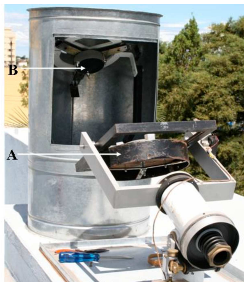
Figura 2 - Na figura da esquerda temos um esquema mostrando o funcionamento do heliostato, onde a letra A indica o espelho móvel, a letra B o espelho fixo e a letra C o tubo do telescópio que se situa no interior da sala solar. Na figura da direita temos uma imagem do Heliostato do Observatório.
