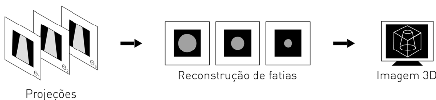
Figura 4 - Resumo das etapas de captação e processamento de imagens obtidas por microtomografia de raios-X (fonte: Ref. [19]).
