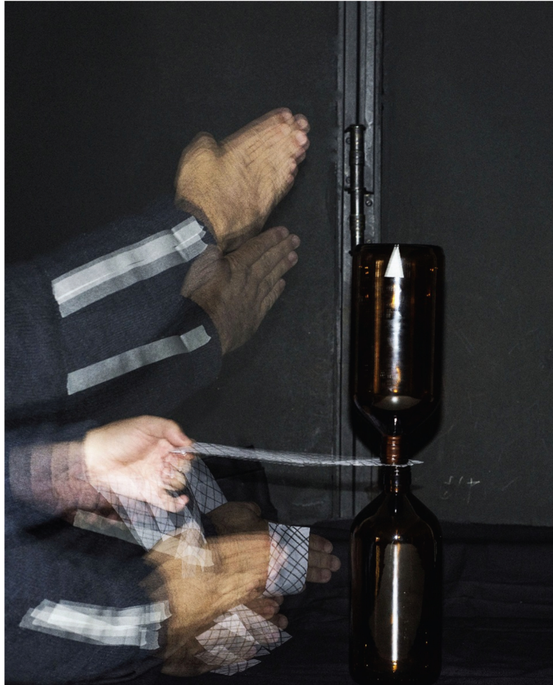
Figura 2: Imagem de múltipla exposição do procedimento de retirada da tira de papel. O intervalo entre dois disparos sucessivos do flash é de 1/20 s. A nitidez das garrafas na imagem (de vidro, cada uma com massa de aproximadamente 0,5 kg), sugere que elas não se movem de maneira perceptível (veja também o vídeo produzido pelos autores em https://youtu.be/NOAwKiVS6VU )
