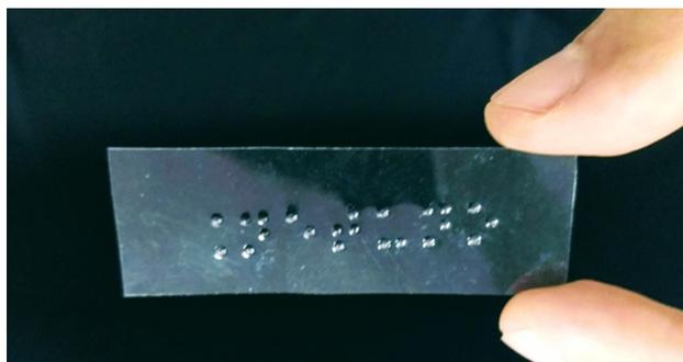
**Figura 2:** Legenda do planeta Netuno feita em papel acetato transparente. Esse material é indicado por possuir boas propriedades mecânicas, fazendo com que a impressão não se desfaça com facilidade.
