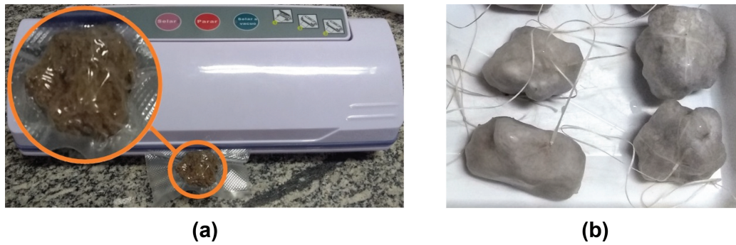
Figura 1: Amostras impermeabilizadas. (a) Método da sela a vácuo: máquina seladora a vácuo com agregado de solo sendo evacuado e impermeabilizado e (b) método da parafina fundida: agregados de solo amarrados com barbantes e revestidos por uma camada de parafina.
