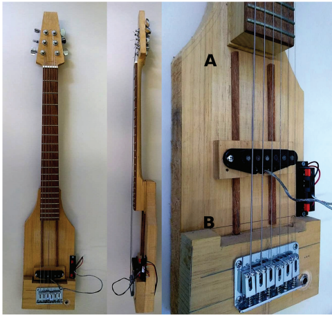
Figura 4: Protótipo construído para demonstrações relacionadas ao posicionamento do captador e a sua influência no som resultante. Possui um único captador que pode se mover em linha reta, através de trilhos, entre o final do braço (A) e a ponte (B). Pode ser ligado a um amplificador como uma guitarra elétrica.
