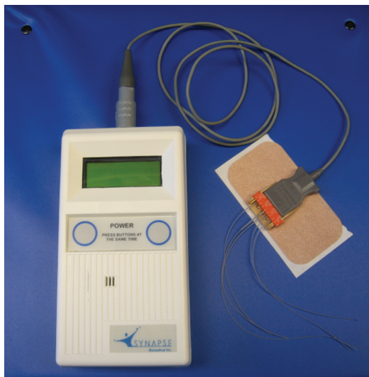
Figura 4 – Marca-passo externo. Notar os fios que se conectam aos eletrodos implantados por via transcutânea no diafragma.
